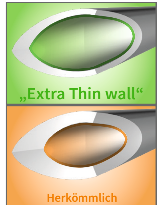
"Extra Thin Wall"-Technologie für optimalen Insulindurchfluss (mehr Durchfluss bei weniger Druck).
